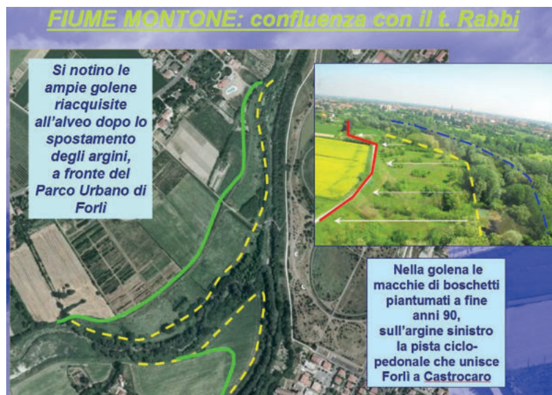
Figura 25. Spostamento argine fiume Montone (Forlì)
